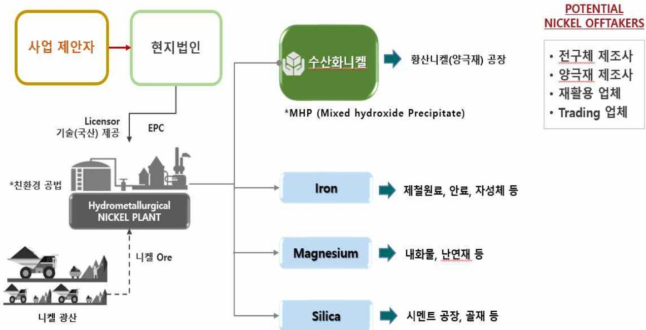
※ 사업제안자는 인도네시아 현지법인을 설립, 기술 및 자본 투자를 통해 현지에 니켈 원광을 가공하는 친환경 니켈 습식제련 Plant를 구축함으로써 주 생산품인 수산화니켈을 생산, 배터리 제조에 필요한 전구체/양극제 회사에 납품하고, 유효 부산물들은 재활용 및 부가 가치화 하고자 함
